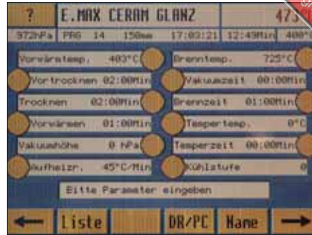
Abb. 89 Die Brennparameter für den Glanzbrand des Veneers
