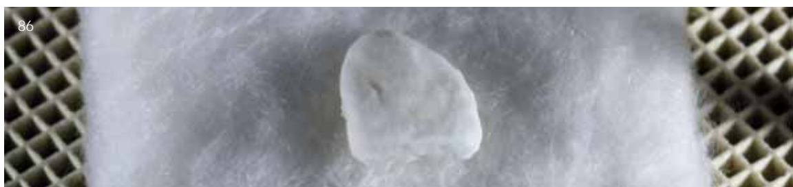
Abb. 86 Auch das Veneer wurde auf Brennwatte gebrannt. Daher ist es besonders wichtig, die Endtemperatur etwa 10°C zu erhöhen, da der Brenträger und die Watte schlechte Wärmeleiter sind
