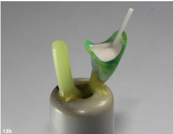
**Abb. 13** Tipp für die Kollegen: **a** Beim Pressvorgang ist der filigrane Stumpf abgebrochen, sodass die Krone nicht zu gebrauchen ist. **b** Abhilfe schaffen hier die von dental emotions entwickelten Aluminiumoxidstifte mit Namen investix, die einfach beim Einbetten in die Kronen gegeben werden und so für eine ausreichende Stabilität sorgen.
