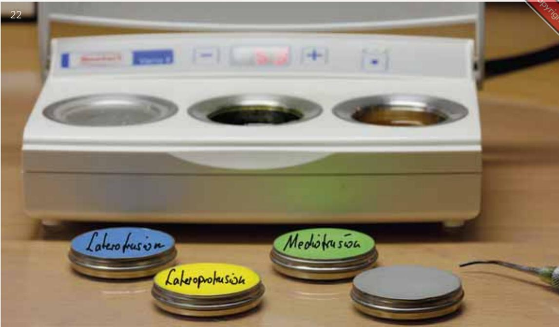
Abb. 22 Die in den Farben der Naturgemäßen Aufwachstechnik (NAT) eingefärbten IQ Wachse erlauben eine nachvollziehbare Modellation, nach der Didaktik von Dieter Schulz
