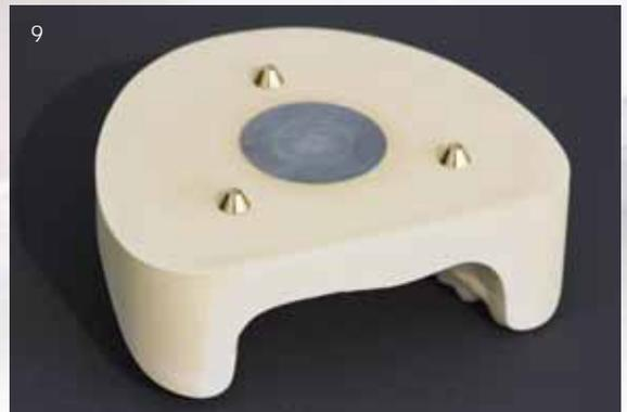
Abb. 9 Die fertige Modellbasis mit eingearbeiteter Haftplatte und eingeklebten Zentrierkegeln
