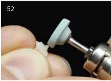
Abb. 52 Die Presskanäle werden ebenfalls bei etwa 8000 U/min und mit wenig Druck verschliffen
