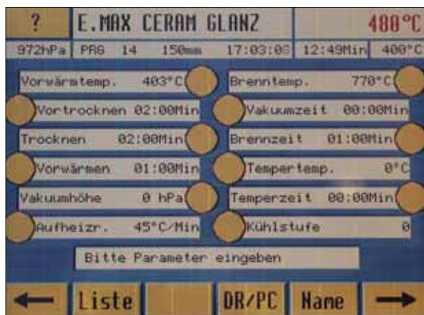
Abb. 62 Die Brennparameter des Glanzbrands für die vollanatomisch gepressten IPS e.max Restaurationen
